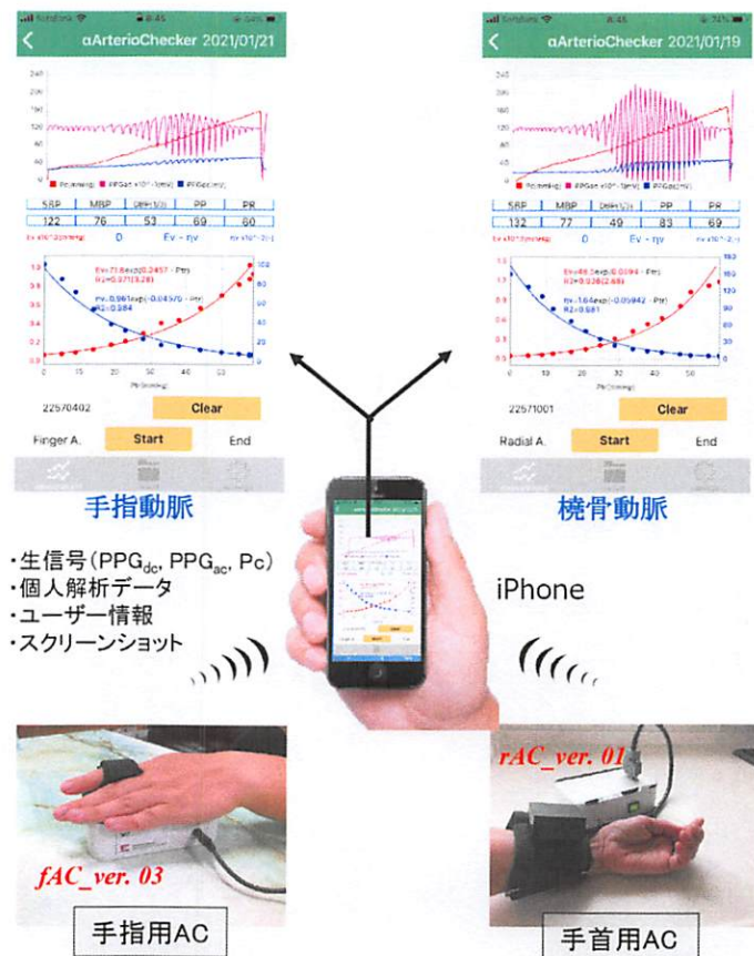
図 2: スマホを利用した手指動脈(左側)・橈骨動脈(右側)硬化度計測装置(アーテリオチェッカー:AC)の計測概要と記録例
